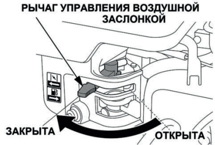
Рис. 9. Воздушная заслонка закрыта
